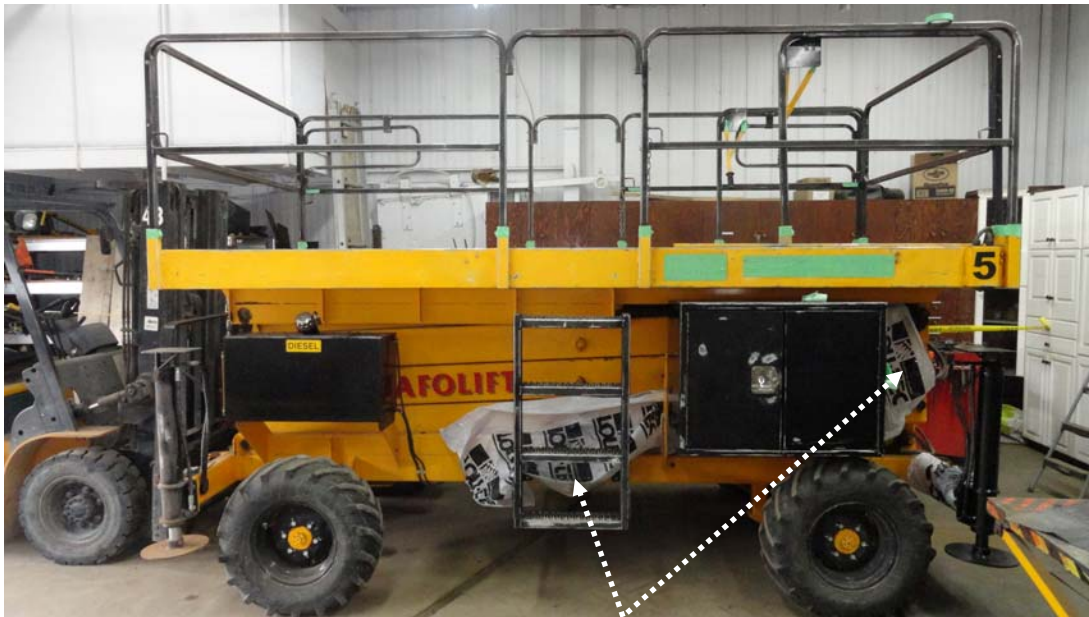
Photo 6 – Plastique protecteur partiellement fixé (Source : CSST)
