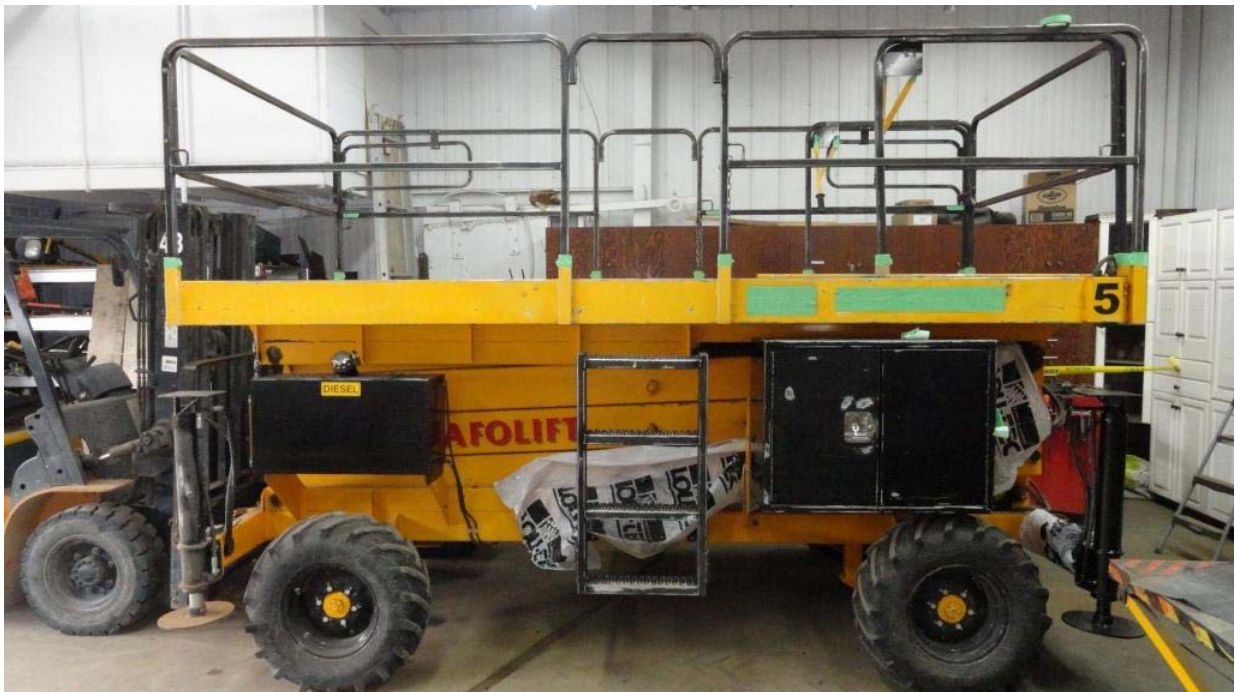
Photo 3 – Plate-forme élévatrice automotrice à l'origine de l'accident (Source : CSST)
